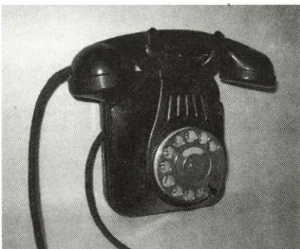
CB 35 típusú készülék falra szerelhető változata
