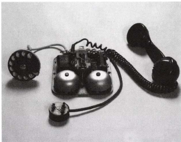
A CB 35 típusú készülék fém alaplagra szerelt szerkezeti elemei
