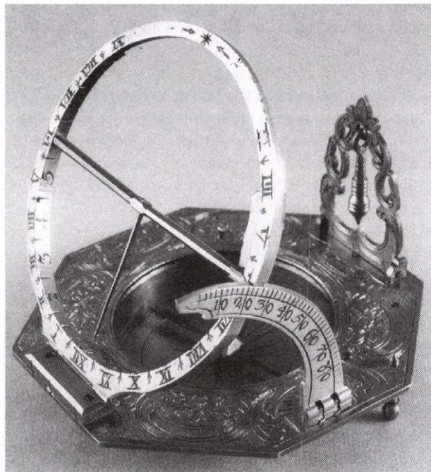
Az egyszerű, pólusra irányított napóra szerkezete: középen a pólusra merőleges, az égi egyenlítő síkjában álló egyenlítői (ekvatoriális) számlap, jobbra a függőleges sík vertikális, alul a horizontális számlap. (J. Ferguson: Mechanical Lecture on Dialling c. 1766-ban kiadott művéből.)
