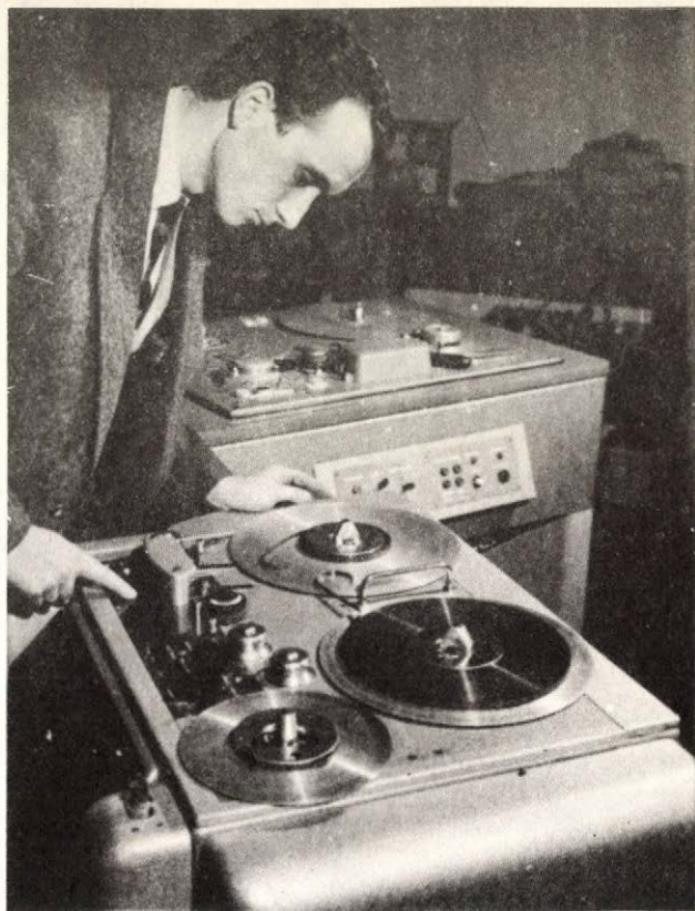
22. ábra. Saját gyártmányú háromtányéros montirozó magnó. A gép mellett Scheidl Antal, 1960-as évek első fele.
