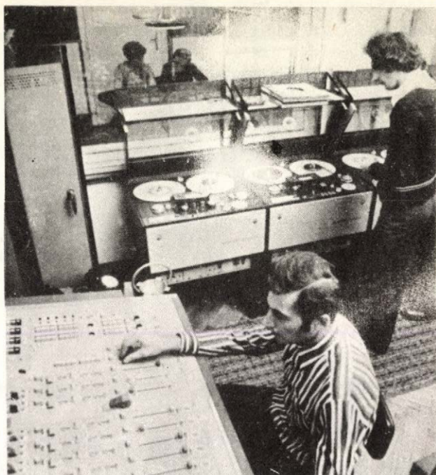
27. ábra. A pécsi stúdió technikai helyisége FIT asztallal és ML STM-200 b magnókkal. A keverőasztalnál Laufer László vezetőtechnikus, 1972.
